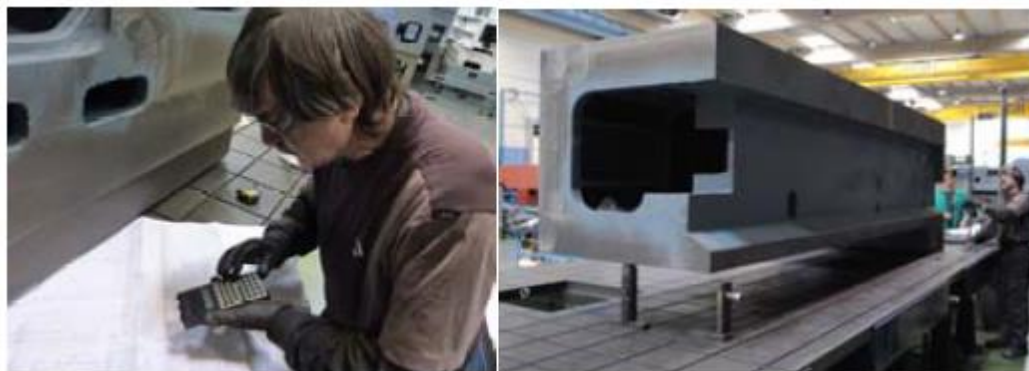
شکل ۱. مثالی از فرآیند اتصالات قطعه خام دستی: محاسبه تنظیم قطعه (چپ) و نشانه گذاری مرجع (سمت راست).
