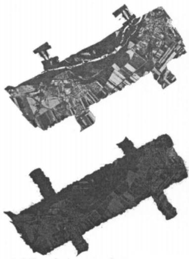
شکل ۳. بازتاب کالیبره شده رادیوسنجی ماموریت پرواز ۲؛ تصویر بالا: nm<sub>1550</sub>، تصویر پایین: nm<sub>532</sub> از هر دو
