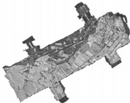
شکل ۴. تصویر بازتاب فعال با چند طول موج که از مجموعه داده های کالیبره شده ALS از نظر رادیومتری برآورد شده است؛ nm<sub>1064</sub> (مقیاس خطی از ۰ (سیاه و سفید) به ۰,۵ (سبز)) و nm<sub>1550</sub> (مقیاس خطی؛ nm<sub>532</sub> از (مقیاس خطی از ۰ (سیاه و سفید) تا ۰,۲۵ (آبی رنگ)) از ۰ (سیاه و سفید) به ۰,۵ (قرمز)).
