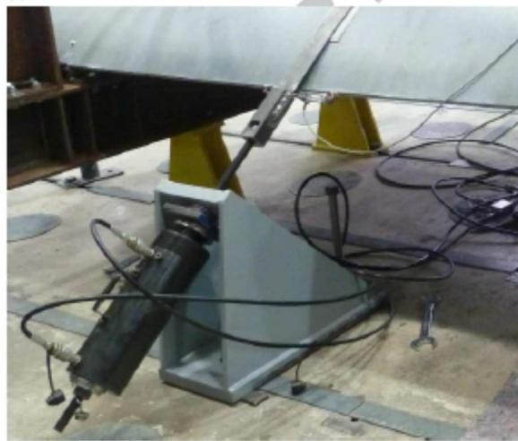
شکل 8 (الف): تنظیمات آزمایش پوسته طاق TRC با شرایط تکیه گاه، بار ها و نقاط اندازه گیری مربوطه؛ (ب) نمونه آزمایش در آزمایشگاه و (ج) جزئیات سیلندر هیدرولیک بری استفاده از بار S (پایین).
