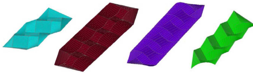
شکل ۵. مدل های سقف های پوسته ای مدولار بر اساس سازه های دوطرفه
