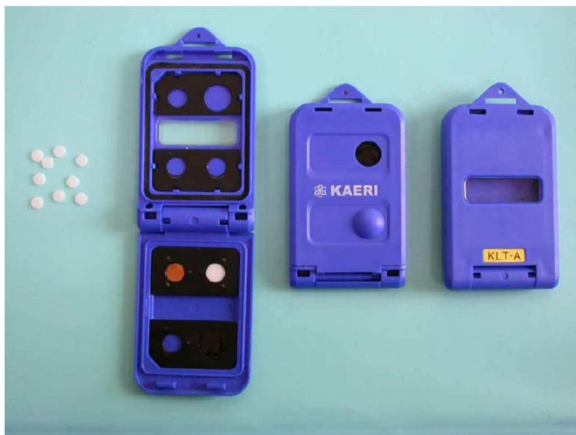
شکل 5: عکس از آشکارسازهای  $\text{LiF}:\text{Mg}$ ،  $\text{Cu}$ ،  $\text{Na}$ ،  $\text{Si}$  و دوزسنج به تازگی توسعه یافته.
