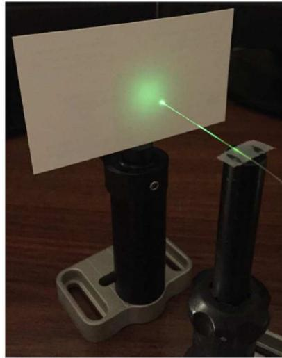
شکل 13- عکس نوک فیبر حالت منفرد با لایه ای از ورقه نانوکامپوزیتی  $\text{NaYF}_4: \text{Yb}^{3+}, \text{Er}^{3+}$  + PMMA که با یک دیود لیزری 980 نانومتری (با قدرت 125mW) پمپ گردیده و قسمت خلفی سفید یک کارت ویزیت را روشن کرده است.
