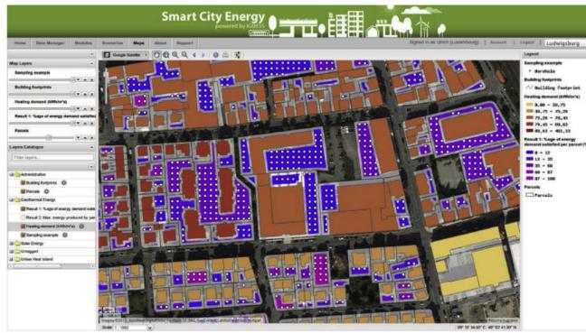
شکل 8- تقاضای گرماسازی و انرژی تحت پوشش پتانسیل زمین گرمایی در پلتفرم انرژی شهر هوشمند برای هر قواره ممیزی زمین. مثال نمونه گیری نشاندهنده سوراخهای گمانه زنی احتمالی به شکل دایره های سفید است که در حدفاصله بین 6 و 3 متر با فراز حاشیه قواره زمین ممیزی لحاظ شده است.
