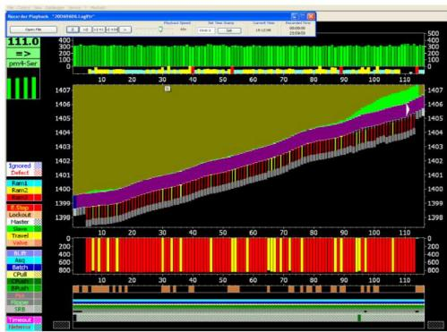
شکل 14- تراز جبهه کار بعد از نصب خودکارسازی LASC (توجه به ثبات و خطی بودن موقعیت جبهه کار و سیستم های تکیه گاه سقف)
