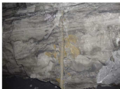
c) حفاری سقف دستی برای شکل دادن به دیوار یکطرفه در دروازه
