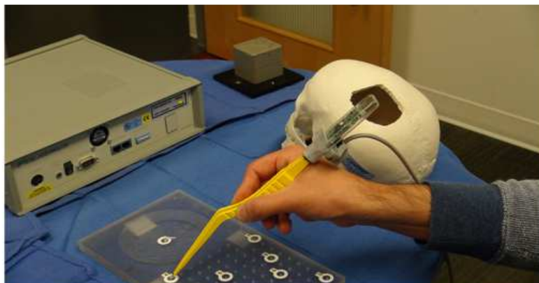
شکل 1: فورسپس دو قطبی 1- شتاب سنج و 2- مسیر یاب
