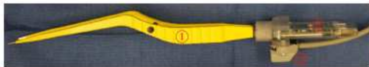
شکل 1: فورسپس دو قطبی 1- شتاب سنج و 2- مسیر یاب
