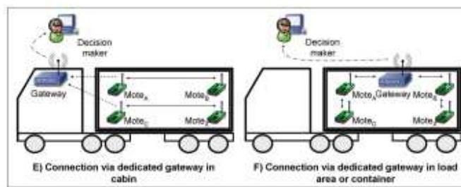
شکل 3. امکان اتصال یک In-Truck-WSN به کاربران نهایی از طریق درگاه های تخصصی
