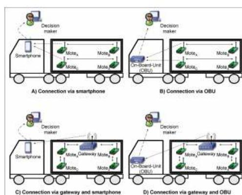
شکل 2. امکان اتصال یک In-Truck-WSN به کاربران نهایی از طریق دستگاه های موجود
