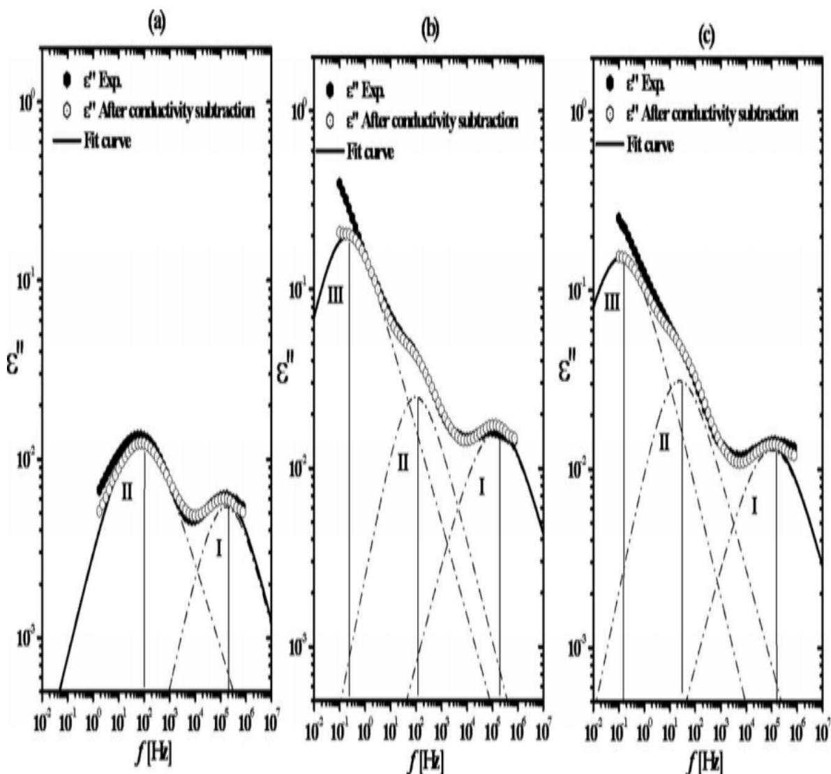
شکل 9: افت دی الکتریک  $\epsilon''$  در برابر فرکانس  $f$  برای پلی استایرن با غلظت های مختلف سیلیکا. الف: تجزیه خالص، ب: PS-10 wt%  $\text{SiO}_2$  و پ: PS-4 wt%  $\text{SiO}_2$  به سه فرایند استراحت پس از تفریق رسانایی در دمای 120 درجه.
