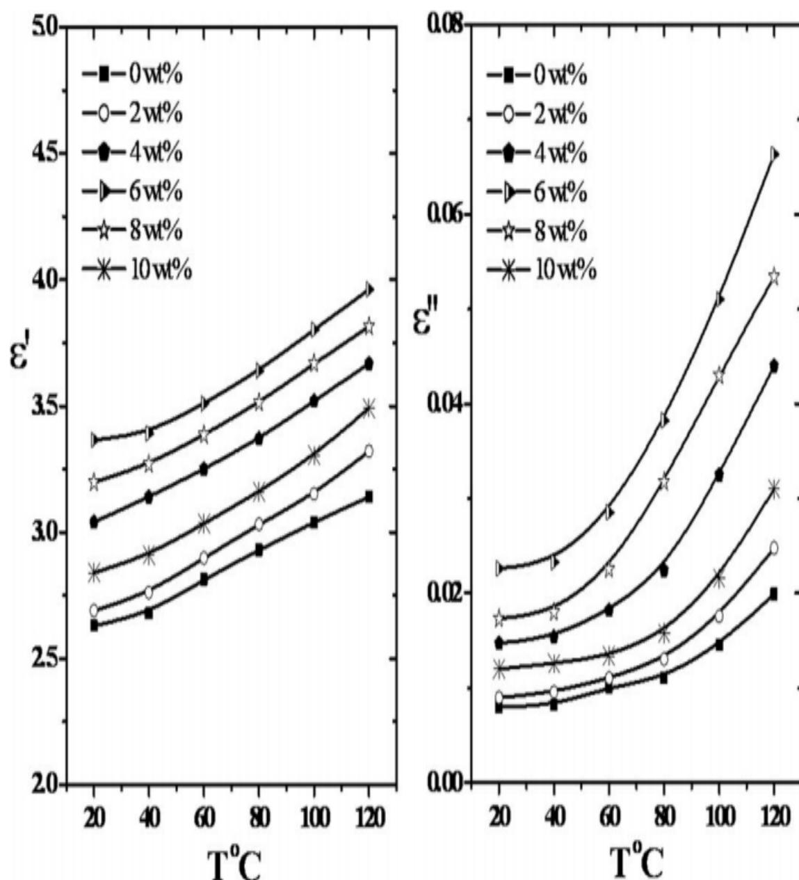
شکل 8: وابستگی گذر دهی  $\epsilon''$  و افت دی الکتریک  $\epsilon'$  بر دما  $^{\text{PS/CTMS/SiO}_2}$
