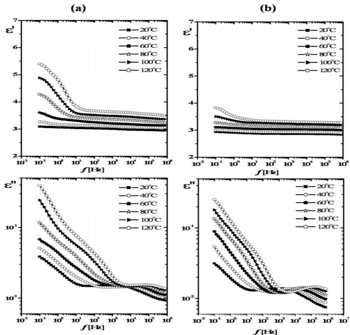
شکل 6: وابستگی فرکانس گزنددهی  $\epsilon''$  و افت دی الکتریک  $\epsilon'$  بر روی غلظت سیلیسیم که در آن الف:
