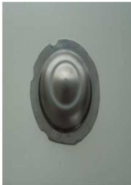
شکل 6: قطعه ورق نهایی تولید شده با ISF بر روی ماشین تراش CNC
