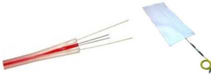
شکل 6: کابل SmartProfile و گنجاندن آن درون یک ژئوتکستایل
