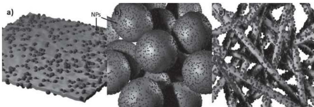
شکل 3: یک نمودار شماتیک نشان دهنده سه نوع نانوکامپوزیت استاتیک
