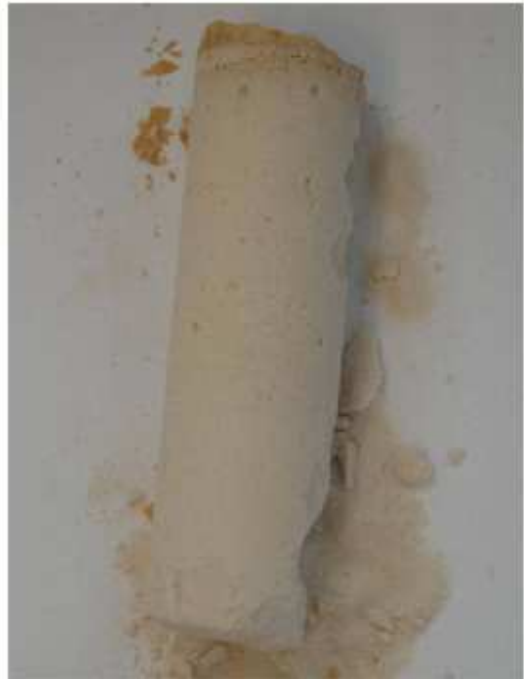
شکل 3 : نمونه سیمان شده بعد از 3 روز 100 \text{ kg/m}^3
