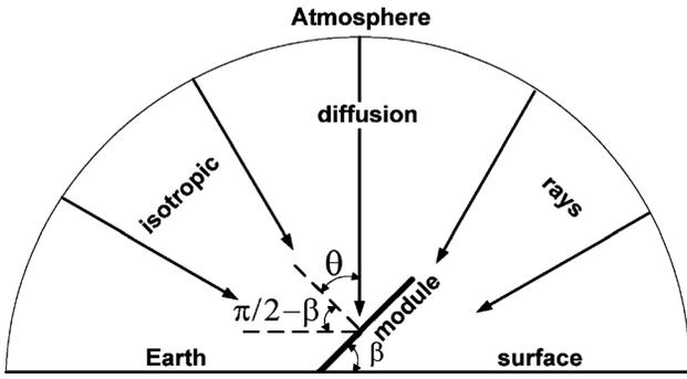
Fig. 4. Isotropic diffusion on the module.
