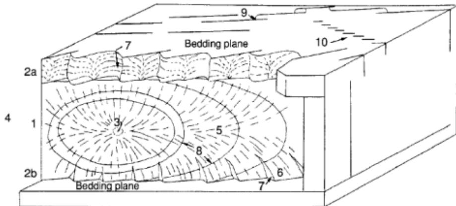
شکل 17: یک دیاگرام بلوکی که نشان دهنده انواع مختلفی از ساختار های سطحی و شکستگی است. 1- رخ درزه اصلی 2- یال کمانش دوقلو 2ب: یال تدریجی 3- منشا شکستگی 4- پلوم هاکل 5- محور پلوم 6- وجه هاکل دقلو 7- مراحل هاکل دوقلو. 8- علایم ریگ 9- هوکینگ 10- شکستگی دقلو EN اکولون های خصوصیات سطحی شکست ها
