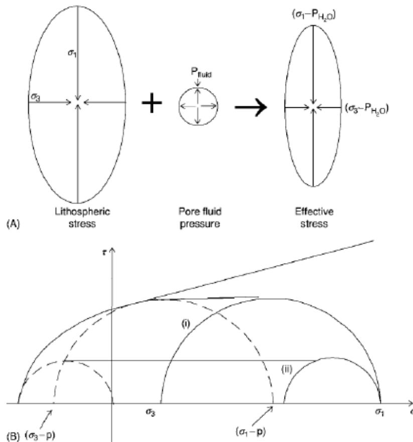
شکل 1:8) نمایش گرافیکی از اثر فشار سیال(حلقه های با فشار رو به بیرون)
