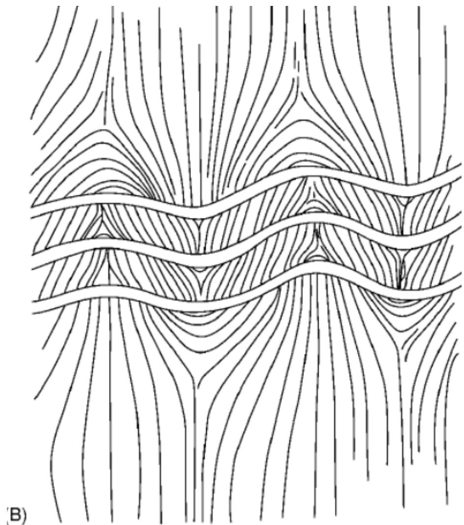
شکل 8-الف: کمانش های تولید شده آزمایشی در مواد ویسکوز که نشان
