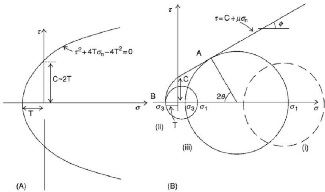
شکل 7: نمایش گرافیکی از معیار گریفیت از شکست برشی معادله 7. این به صورت سه‌می است که با محور فشار نرمال متقطع بوده و دارای مقاومت برشی و محور فشار برشی پیوستکی است. ب: معیار های کامل برای شکنندگی با ارتباط دو معیار در نقطه‌ای ایجاد می شود که شبیه آن‌ها مشابه باشد.
