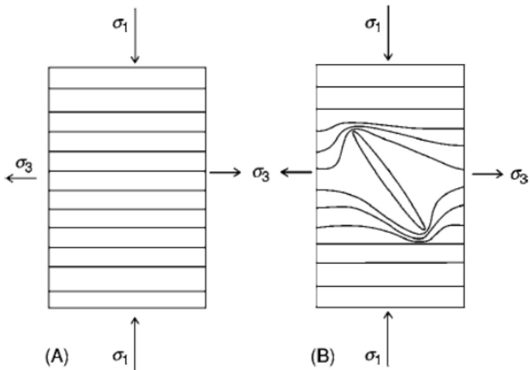
شکل 6 الف: میدان فشار یکنواخت که با صفحات فشار با فاصله یکنواخت در لایه کشیده شده نشان داده شده است. ب: تمرکز فشار کششی در نوک ترک در یک لایه یکنواخت.
