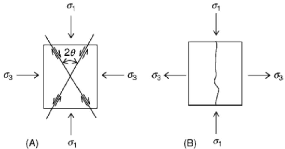
شکل ۱: دو حالت شکست شکننده A: شکست برشی و B: شکست کششی.
