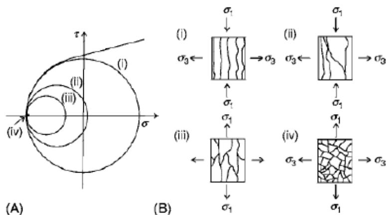
شکل 9: حلقه های فشار موهر نشان دهنده‌ی طیفی از حالت‌های فشار است
