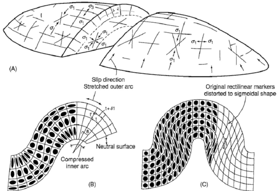
شکل 20:الف. شکستگی های مربوط به یک تاقدیس. ب/م توزیع کرنش
