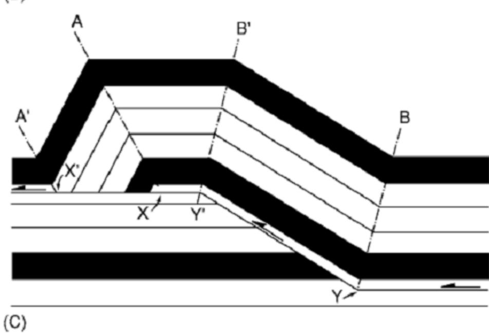
به علاوه، شکستگی ها همراه با چین خوردگی و جهت یافته شکستگی ها ایجاد شده و نشان دهنده این است گه آن ها در یک میدان فشاری طی چین خوردگی ایجاد شده اند (شکل 19).
