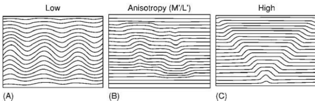
شکل 9: ساختار هایی که زمانی تشکیل می شوند که یک ماده دارای ناهمسان گردی مکانیکی نظیر مواد اصلی لایه های رسوبی موازی با لایه بندی تحت فشار قرار می گیرد. بسته به ناهمسانگردی که آن ها ا متغیر از چین های بالا رونده با صفحات مجوری با فشار اصلی با چین های جعبه ای که متمایل به فشار می باشد هستند.
