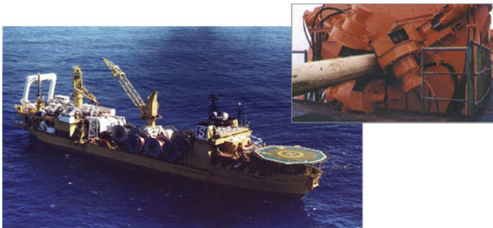
شکل 8: محفظه ی نگهدارنده لوله (PLSV) و کشنده ی آن (Rabelo . 2013)
