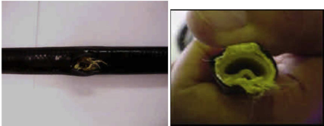
شکل 11 : شکست لوله هیدرولیک تحت عملیات (Rabelo . 2013)
