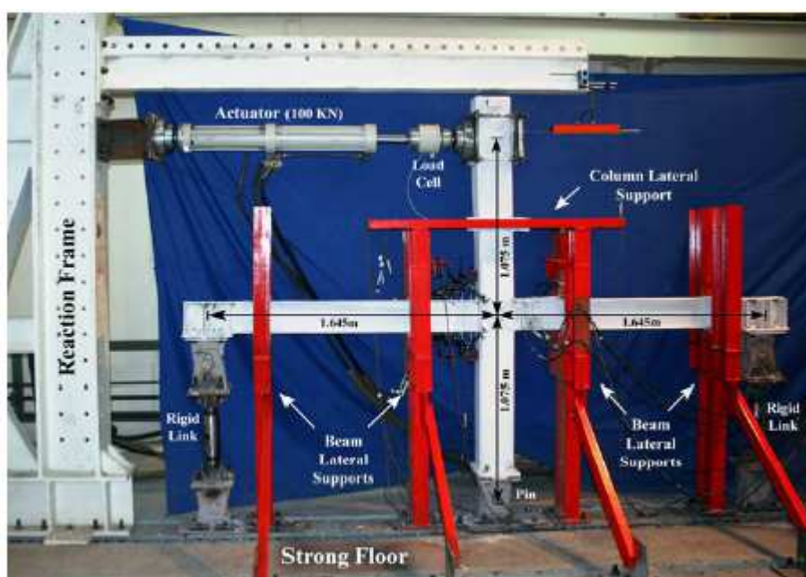
شکل 5. پیکربندی تنظیمات آزمایش و ابعاد کلی نمونه‌ها (تصویر آزمایش نمونه 1)
