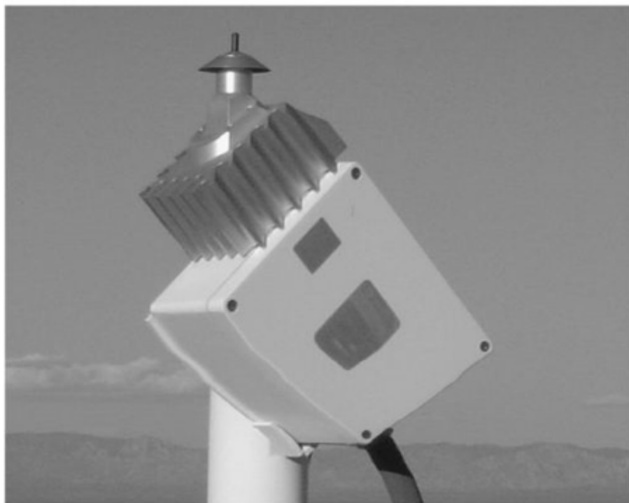
تصویر 13. شناساگر از نوع کاوشگر برای اندازه گیری باران یخ زده و نم یخ زده باران.
